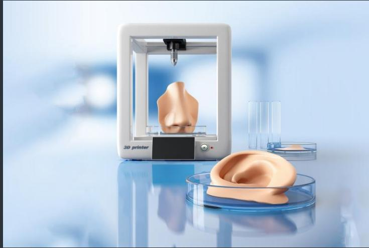
3D printanje je proizvodna tehnologija za koju je specifično da se predmet izrađuje dodavanjem materijala sloj po sloj. Osim uštede materijala u odnosu na klasične tehnologije obrade (glodanje, tokarenje i sl.) kod kojih se oduzima višak materijala, tehnologija 3D ispisa omogućuje stvaranje predmeta direktno iz računalnog 3D modela.
